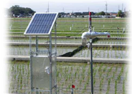
精度の高い通風式気温計を自作し、検証！
