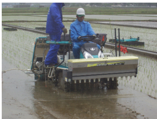
図1 有機質資材の田植同時散布（K社製、前装ライムソー、DC12V、散布幅1.8m）
