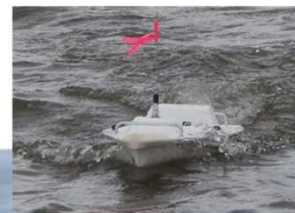
ラジコンボートによる浅海域の測量
