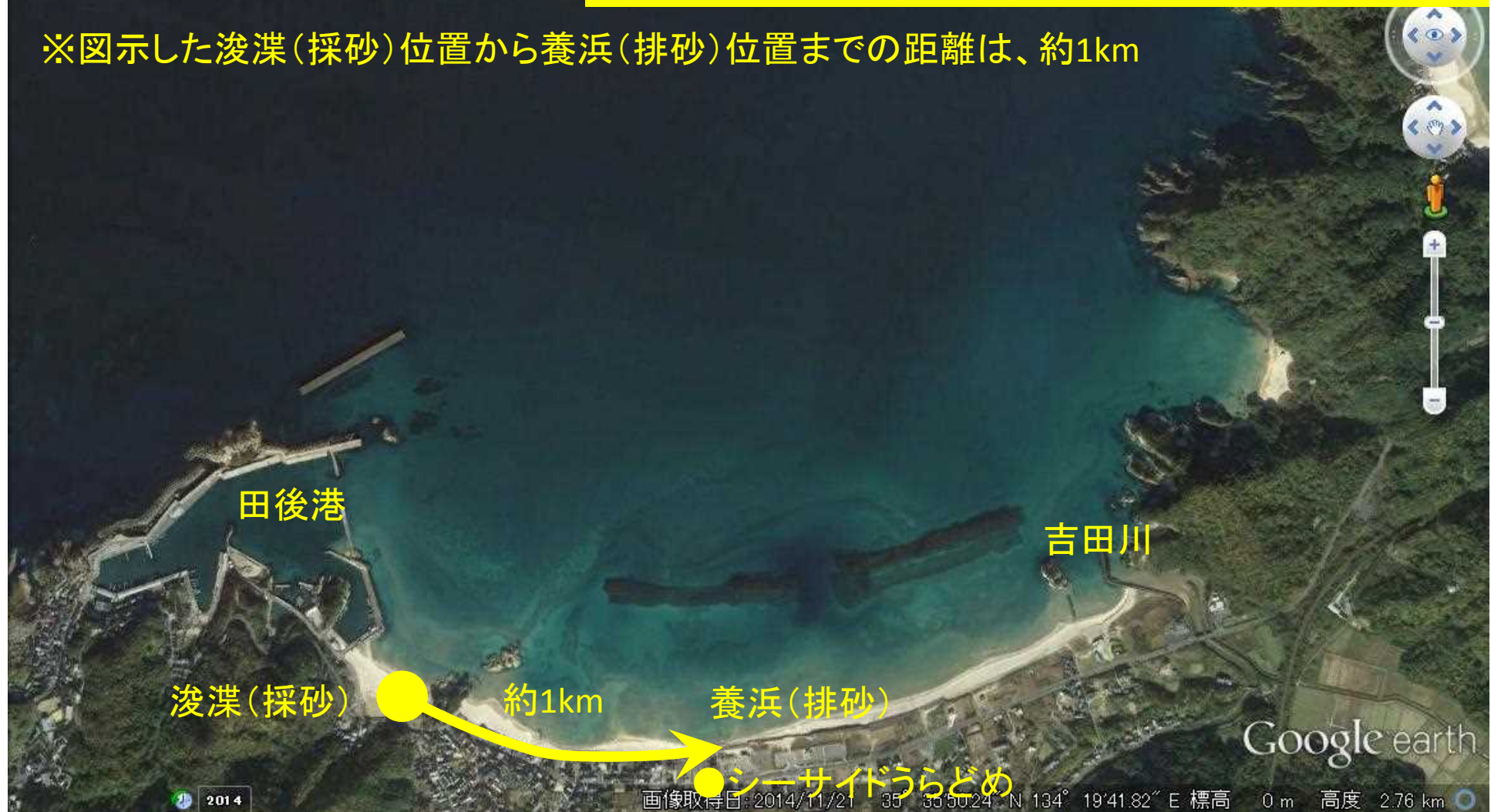
図-8 砂除去装置を用いたサンドリサイクル工法の適用(案)
