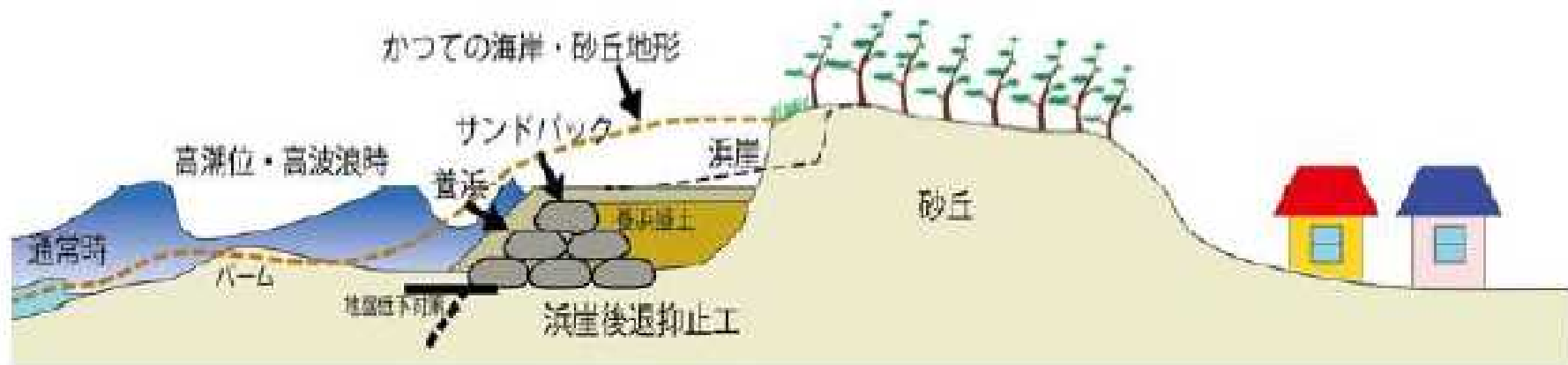
図-1 サンドバックを用いた浜崖後退抑止工法の概念図
