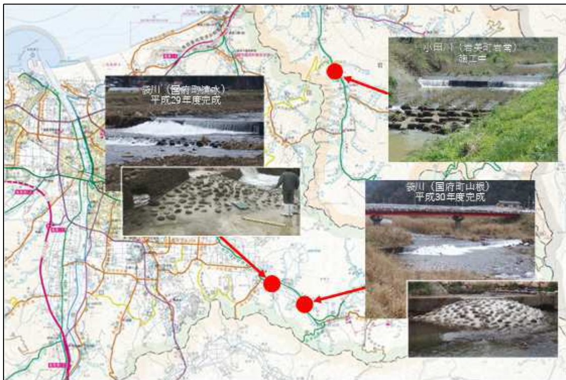
図 12 鳥取県土木部が水辺のネットワーク事業で修繕した魚道
