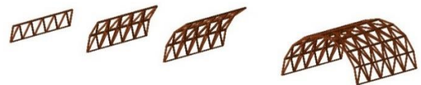
(b) ユニットの結合によるヴォールトの組立 図5 ユニット式ヴォールト構造の組立法
