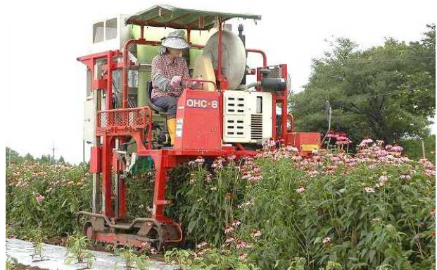
図2 乗用茶刈機を利用したエキナセアの収穫
