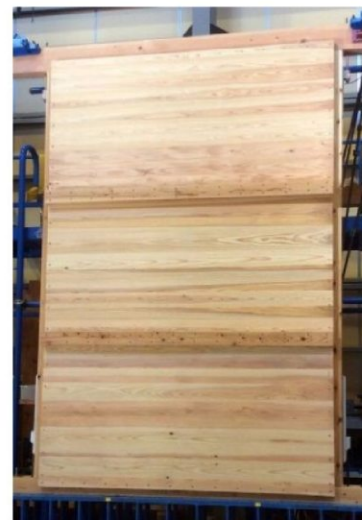
◇スギCLT耐力壁
