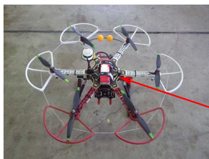
写真 1 試作機体 飛行時総重量 2.2 kg
