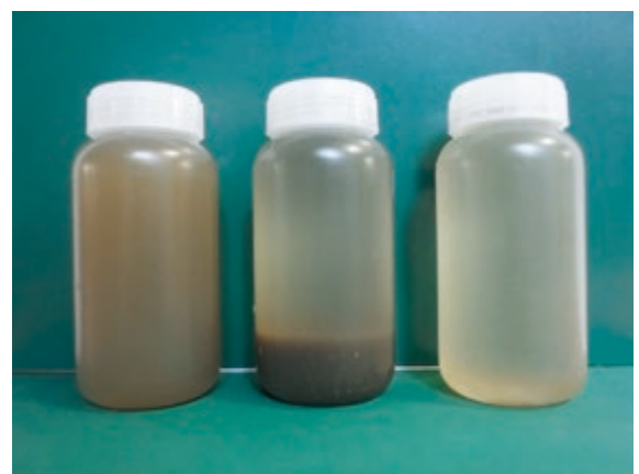
畜産農場からのはい水 左：しより前の水 中：しより中の水 右：しより後の水
