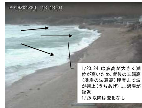
図 3-15 左図 : CCTV 画像で確認される主な入射・遡上状況、右図 : 潮位と有義波高の関係
