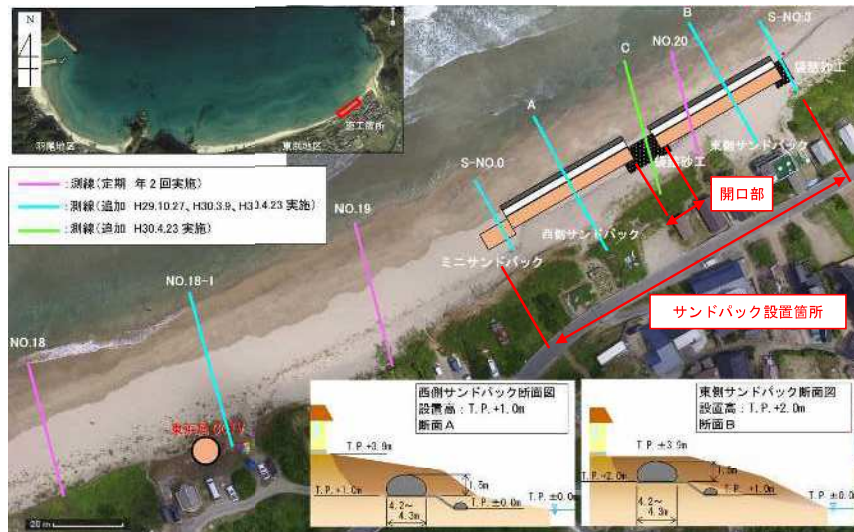
図 4-1 サンドバック設置箇所及びモニタリング（測量）実施箇所
