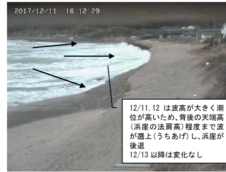
図 3-12 左図：CCTV 画像で確認される主な入射・遡上状況、右図：潮位と有義波高の関係
