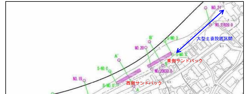
図 4-5 大型土嚢の設置位置図
