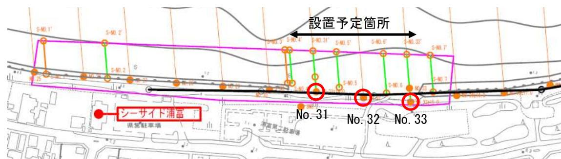
図 5-4 サンドバック試験施工予定箇所周辺の断面重ね合わせ図
