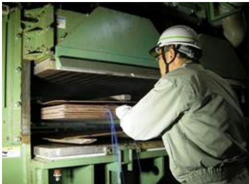
図 1 生産設備による製造実験 ◆加熱接着の際に材内の温度を測定
