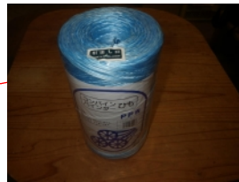
①元柱から先柱へロープを2回運搬 PP ロープ 1巻 1000m 1.4kg
