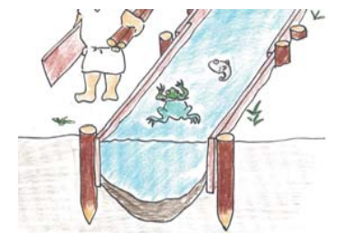
護岸 板材を杭で固定し、水路の護岸としています。
