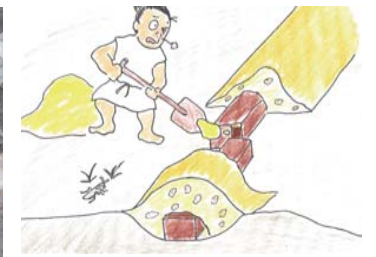
土手の芯材 角材を縦に並べ、それを芯として土手を形成しています。
