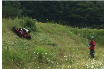
リモコン操縦式自走草刈り機による法面作業 (R元.7)
