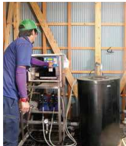
システム機器に肥料の割合や供給のタイミングを設定（上）定植直後のトマトの苗。土壌に見える配管はシステムから伸びている（左）
