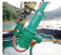
スクリュー破砕機 油圧で石を破砕して吸引します
