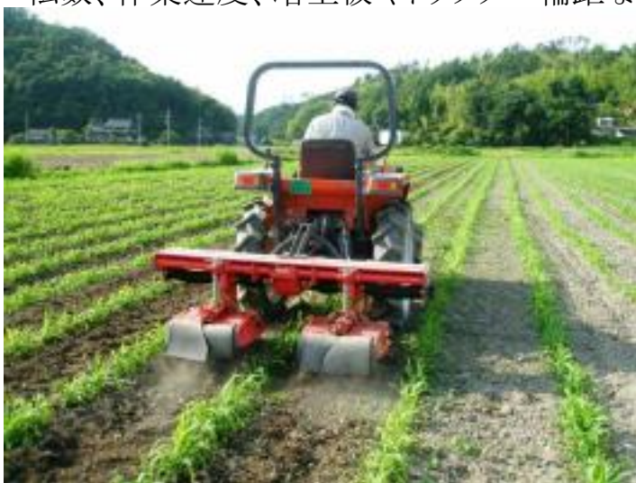
写真 11 ロータリカルチによる中耕作業
