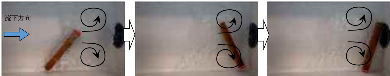
写真 a) ウイング角度0° : 呑口周囲に生じた渦流 (写真中の黒矢印) により丸棒が回転し、呑口に詰まる
