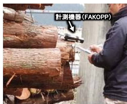
図3 SPTの測定状況
