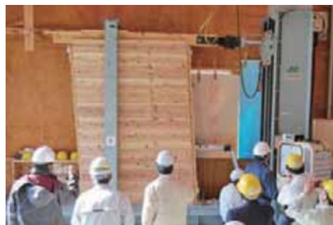
壁の強さを調べる実験
