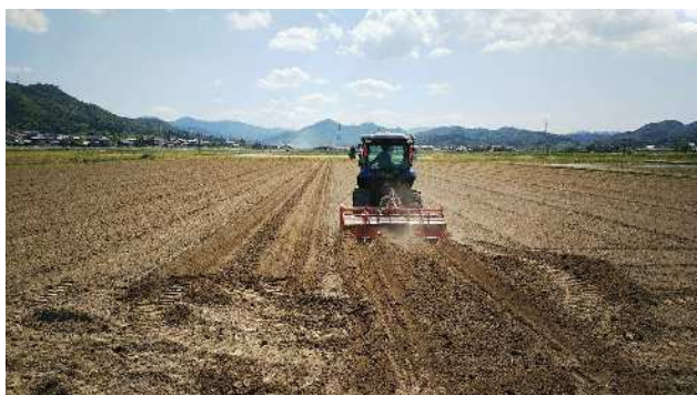
自動操舵による白ネギの植え溝掘り (R2.5)
