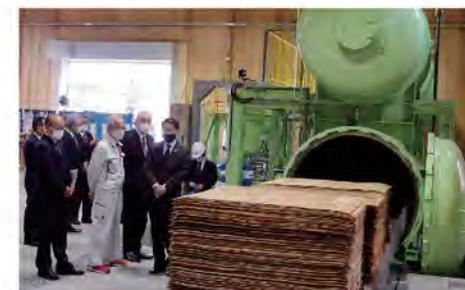
LVL用単板を薬剤含浸装置に投入するところ (令和2年11月2日 新工場起動手)
