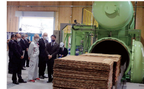
LVL用単板を薬剤含浸装置に投入するところ(令和2年11月2日 新工場起動手)
