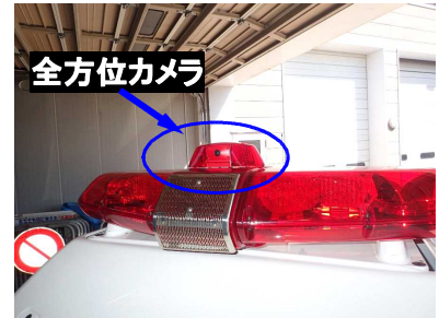
【全方位カメラの設置状況】
