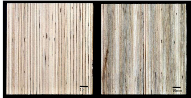
図1 従来品:4mm単板試験片(左)と薄単板:1.2mm単板試験片(右)の積層面試験片(L:100mm×W:100mm×T:30mm)
