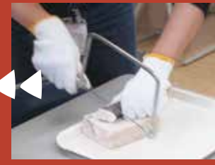
鹿角の切断から。まず糸鋸で溝をつけます。ギコギコ。
