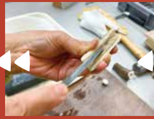
うまく切断できたら成形作業。やすりでゴリゴリ。必要なのは根気のみ！
