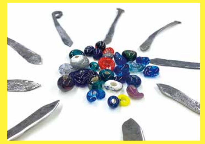
ガラス棒を熱し、溶けてきたら鉄棒にくるくる回しながら、まきつける。
