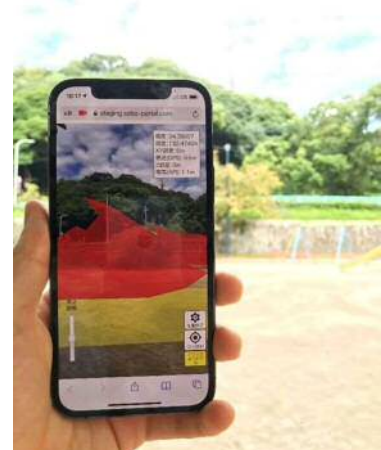
(土砂災害警戒区域などを現地で見える化)
