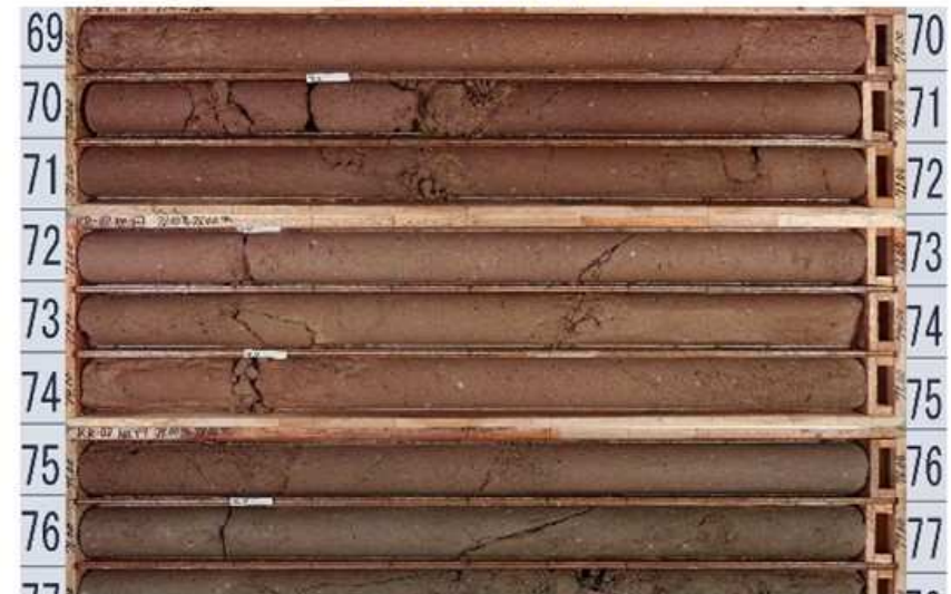
写真③: ボーリングコア写真 (KR02-No.9-1:GL-65.10～78.50m)
