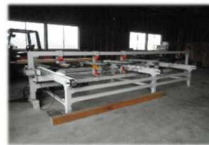
グレーディングマシン (強度等を調べる測定器)
