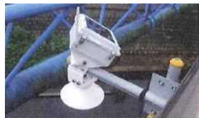
低コスト型水位計の設置例
