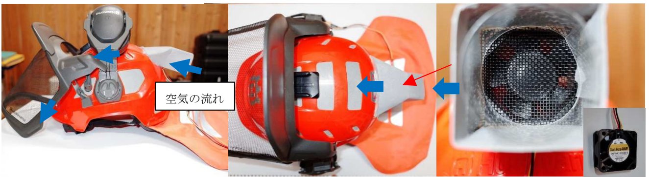
写真-1 ヘルメット Husqvarna H300 電動ファン(防水仕様) SanAce40W DC12V 0.1A 0.225m3/min (帽体には一切加工を加えてはいない)
