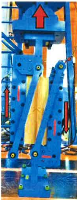
写真1 試験状況 (平行条件) ※矢印は加力方向を示す
