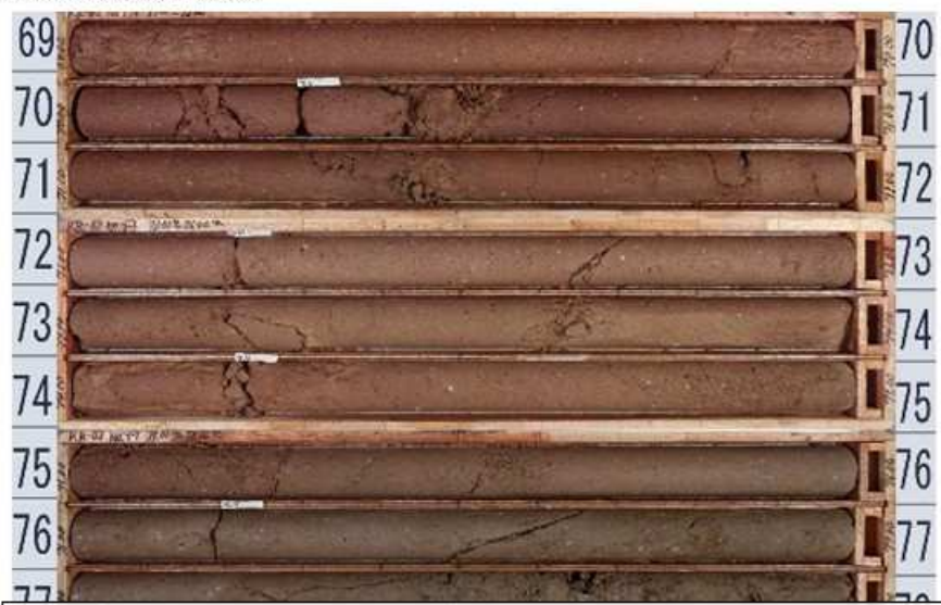
写真③：ボーリングコア写真 (KR02-No.9-1:GL-65.10～78.50m)
