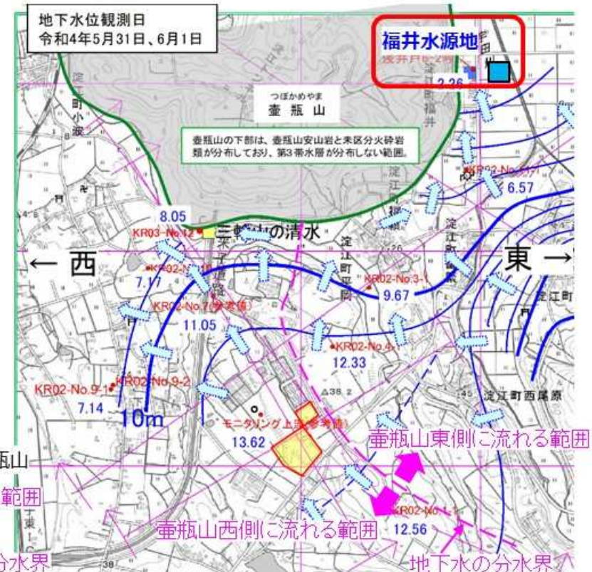
図-2 第3帯水層の地下水位等高線図から推定される地下水流向
