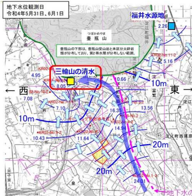
図-1 第2帯水層の地下水位等高線図から推定される地下水流向
