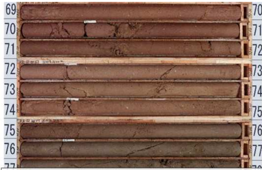
写真③：ボーリングコア写真 (KR02-No.9-1:GL.-65.10～-78.50m)
