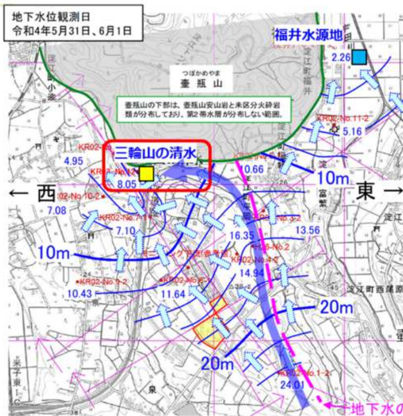
図-1 第2帯水層の地下水位等高線図から推定される地下水流向
