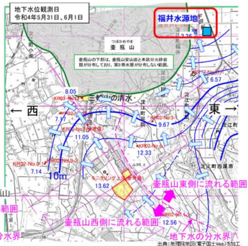
図-2 第3帯水層の地下水位等高線図から推定される地下水流向
