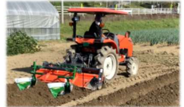
作業効率アップのためネギ用溝切機(作業機)を導入
