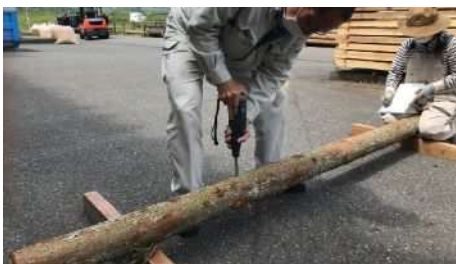
写真1 シュミットハンマーでの計測(鉛直方向)
