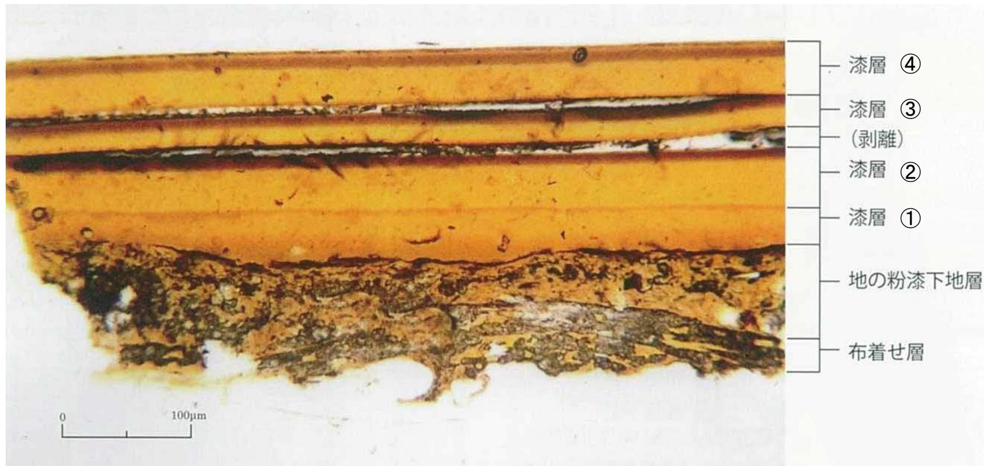
塗膜断面の顕微鏡写真
