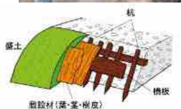
弥生時代中頃(2000年前)の護岸施設
