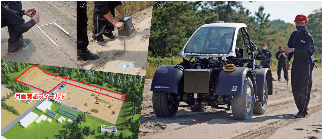
①～③ 鳥取砂丘で(株)ブリヂストンが昨年実施した月面探査車用タイヤ実証実験の様子 ④ 鳥取砂丘月面実証フィールド鳥瞰図(CG)
