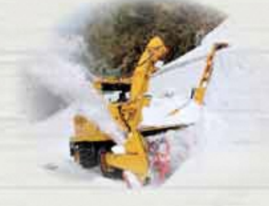
ロータリー除雪車(鍵掛峠付近)
