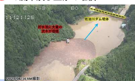
4 佐治川ダム（鳥取市佐治町尾際）の流木及び土砂の堆積
