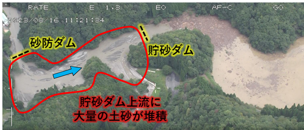
台風7号の出水で土砂が堆積(佐治川ダム上流砂防ダム監視カメラ)
