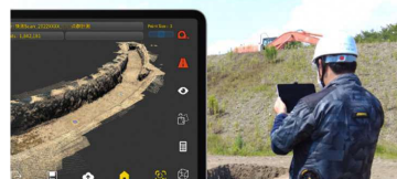
LiDAR（iPad）を使った3次元測量
