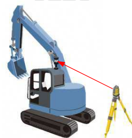
ICT建機（杭ナビシヨベル）
