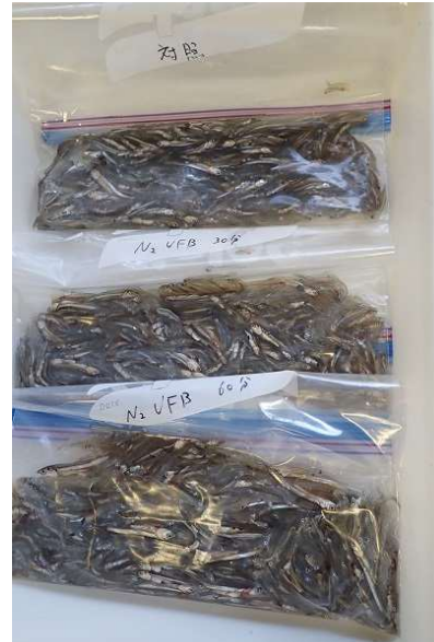
写真 2 窒素 UFB で UFB の浸水時間別で処理したかえり（カタクチイワシ稚魚）の比較（上：無処理（対照区），中：30分浸漬，下：60分浸漬）
