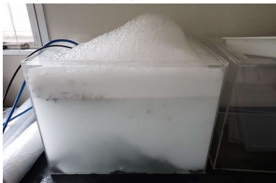
写真 1 かえり（カタクチイワシ稚魚）を入れ，窒素 UFB で脱酸素処理中の水槽の様子
