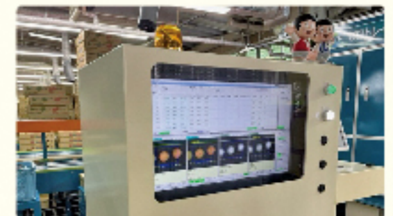
AI判定システムがトマト1玉1玉の色、形、重さを瞬時に判別
