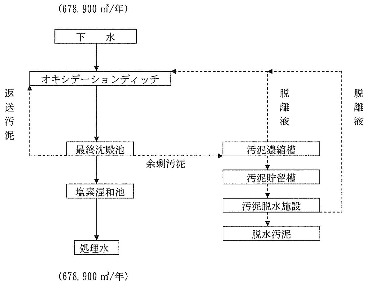
図2 下水処理場の配置図
